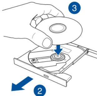
4. ディスク中央部の両端がスピンドル(軸)にパチンと留まるまで押します。
