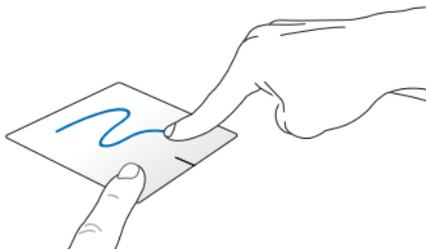
选择图标之后按住左键，然后用另一根手指在触摸板滑动拖曳该图标，然后放开图标将其放置于新的位置。
