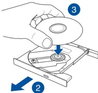
4. Drücken Sie das Medium auf die Kunststoffachse, bis es sicher auf der Achse des optischen Laufwerks sitzt.
