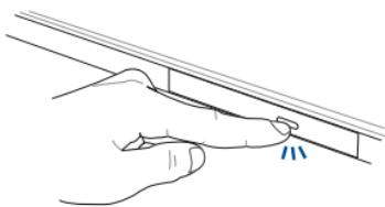
2. Осторожно потяните за переднюю панель привода и полностью выдвиньте лоток.
