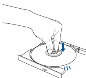
5. Осторожно задвиньте лоток привода на место.
