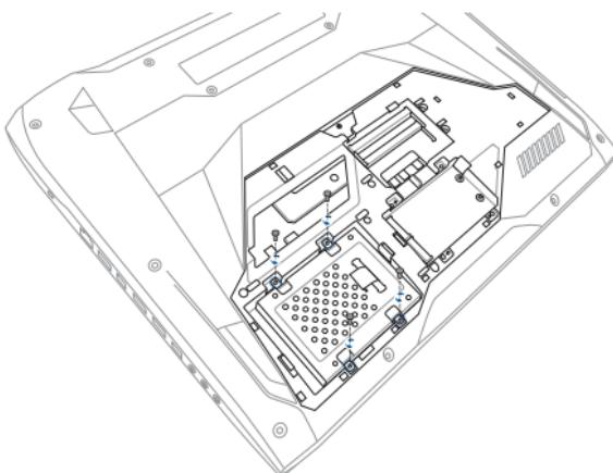
G. 将硬盘托架与硬盘插槽分离并从插槽中取出硬盘托架。
