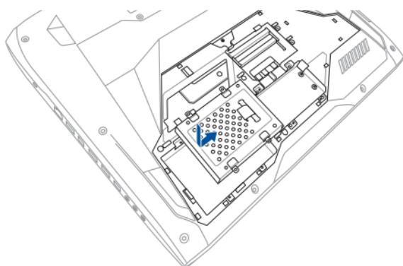
N. 重新安装之前移除的螺丝以固定硬盘托架。
