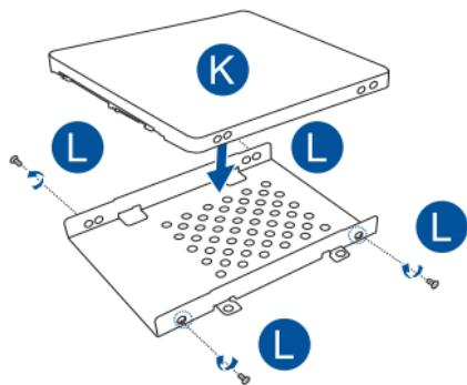
M. 将硬盘接口对准笔记本电脑的硬盘接口，把硬盘托架重新放回插槽。将硬盘托架推入直到与笔记本电脑连接。
