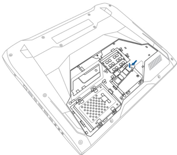
G. 使用匹配的螺丝将 M.2 卡锁入固定。
