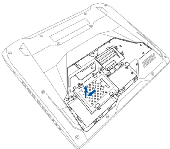
H. 将硬盘托架上下翻转然后移除螺丝。
