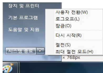
**최대 절전 모드**는 현재 데이터와 상태를 하드디스크 드라이브에 저장합니다. 이 기능을 사용하면 RAM은 정기적으로 데이터를 재생하지 않아도 되기 때문에 전원 소모를 확실히 줄일 수 있습니다. 전원 소모를 완전히 제거하지 못하는 이유는 LAN과 같은 몇몇 기능들이 켜져 있기 때문입니다. “최대절전모드”는 “절전모드”보다 더 많은 절전 효과를 가져옵니다. **시작** 버튼과 화살표 아이콘을 누르면 이 옵션을 확인할 수 있습니다. 전원 버튼을 누르면 다시 복구가 가능합니다. (참고: 이 모드를 사용하면 전원 표시등에 불이 들어오지 않습니다.)
