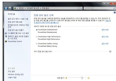
절전은 STR (Suspend-to-RAM)과 같은 기능으로 현재 사용 중인 데이터와 상태를 모두 RAM에 저장하고, 다른 구성 요소를 끄게 됩니다. RAM은 휘발성이기 때문에 데이터 유지를 위해 전원 공급을 필요로 합니다.
