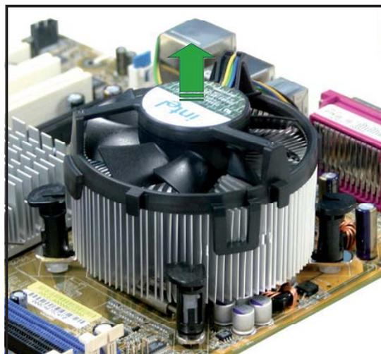
5. Tournez chaque attache dans le sens des aiguilles d'une montre pour qu'elle soit orientée correctement en vue d'une future réinstallation.
