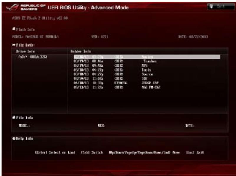
3. キーボードまたはマウスを使用して、**Driver Info**フィールドの最新のBIOSファイルを保存したUSBフラッシュメモリードライブを選択します。操作するフィールドはキーボードの<Tab>で切り替えることができます。
