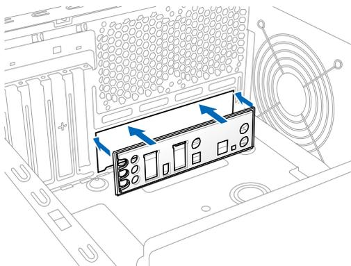
2. 然后将主板装入机箱内，确保主板后侧 I/O 接口对准机箱后侧 I/O 面板。
