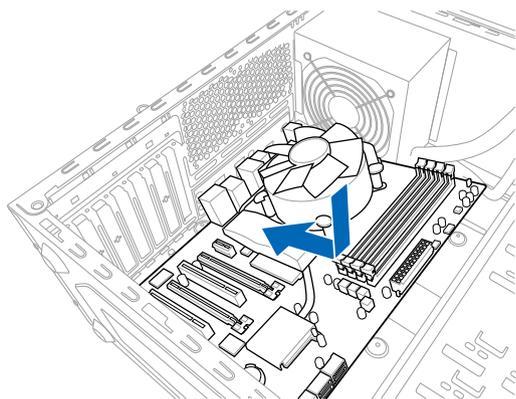
3. 将下图所圈选出来的“六”个螺丝孔位对准主机机箱内相对位置的螺丝孔，然后再一一锁上螺丝固定主板。
