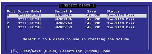
5. 请使用上/下方向键来选择硬盘设备，确认后请按下 <空格> 按键来进行选择。然后被选定的硬盘设备旁便会出现一个小三角形图标。当要进行阵列设置的硬盘设备选择完毕后，请按下 <Enter> 按键。
