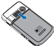
2. 請以手指壓入凹槽，再將電池掀起，便可以移除電池。
