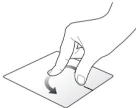
タッチパッド上で指2本を使用し、1本を軸にして時計回りまたは反時計回りの円を描き、画像を回転させます。
