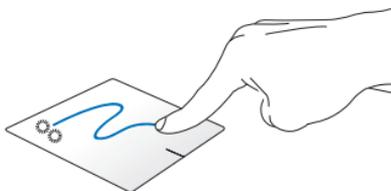
項目をダブルタップ/クリックし、そのままスライドします。指先をタッチパッドから離すと、ドロップされます。
