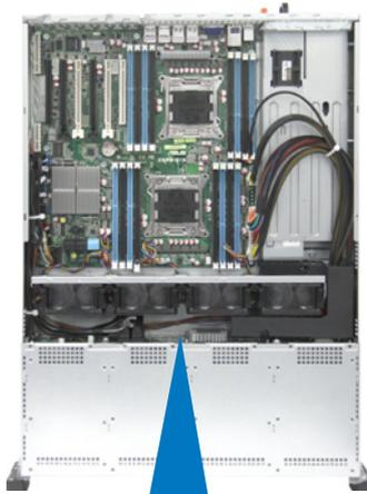
用排线连接至主板上的 SAS 插座。在使用这些插座前，请安装选购的华硕 PIKE 连接电源 (PSU) 的 8-pin 电源 SAS RAID 卡或其他厂牌的 RAID 卡。
