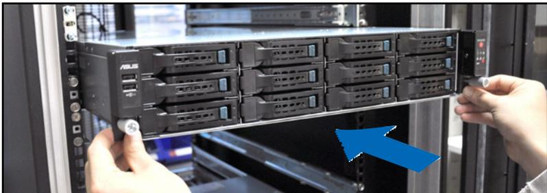
2. 再将服务器左右两边锁上位于机架旁的螺丝，完成安装。
