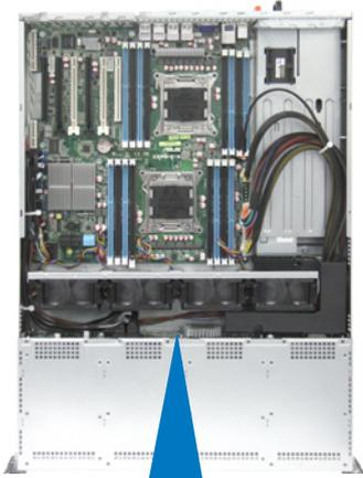
连接电源 (PSU) 的 8-pin 电源
