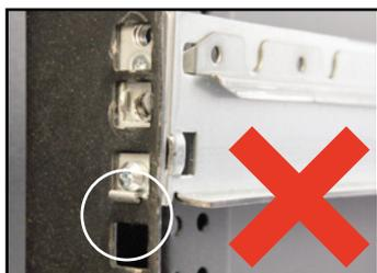
请不要将滑轨挂钩勾在安装孔上的薄型间隔里。
