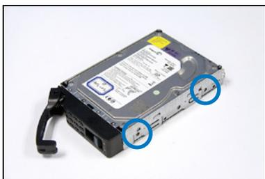
5. 硬盘安装完毕后，请以手紧握握把，将硬盘槽轻推至机箱底部，直到硬盘槽的前端只剩一小部份突出于外。
