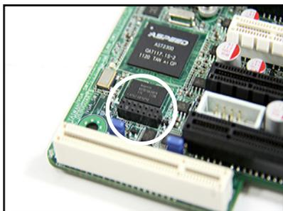
2. 将管理卡取出，然后将针脚对准插槽，方向则如右图所示。
