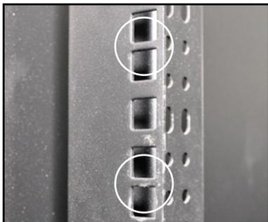
3. 从机架内，将滑轨后端固定勾放置在这下方薄型间隔的后方安装孔，然后将滑轨前端固定勾放置在下方薄型间隔的前方安装孔，如右图所示。
