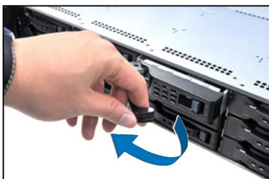
3. 接着再将此硬盘槽从抽换槽中取出，每个槽左右侧各具有三个螺丝安装孔，请一侧使用两颗螺丝进行安装。
