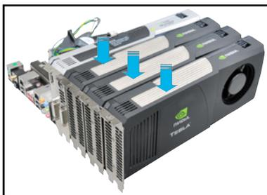
2. 将电源 (PSU) 上提供的任一个 8-pin 电源接口或两个 6-pin 电源接口, 连接至 Quadro 显卡与 Tesla 电脑存取卡。
