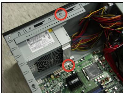
5. 如右圖所示，將固定支撐架上的兩顆螺絲鎖上，完成安裝。
