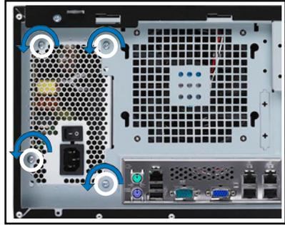
5. 如右圖所示，將機殼內電源供應器周圍的固定支撐架上的兩顆螺絲鬆開。
