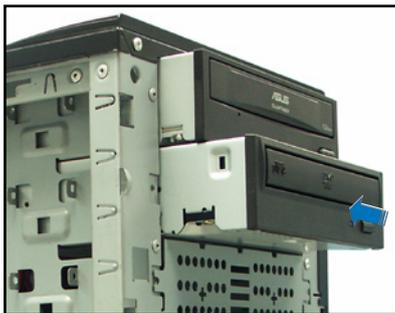
3. 確認光碟機有對到機殼上的孔位，並與機殼的正面面板切齊在同一個位置上。
