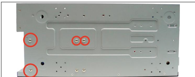
4. 將前面組合好的耳片，使用螺絲鎖上機殼的頂部。
