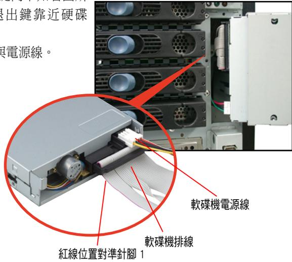
3. 接著請將軟碟機小心地推回機殼的軟碟機槽中，直到軟碟機外圍托架與機殼切齊。
