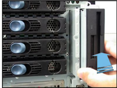
4. 最後請用螺絲起子將軟碟機金屬托架鎖緊於機殼上。
