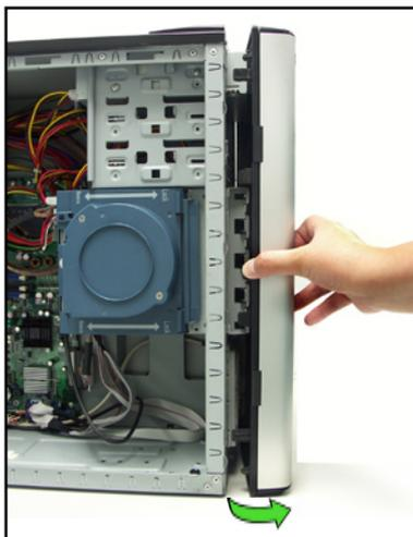
4. 請將位於前面板右側的掛鉤由機殼右側的孔中鬆開，讓前面板組件可以徹底脫離機殼。
