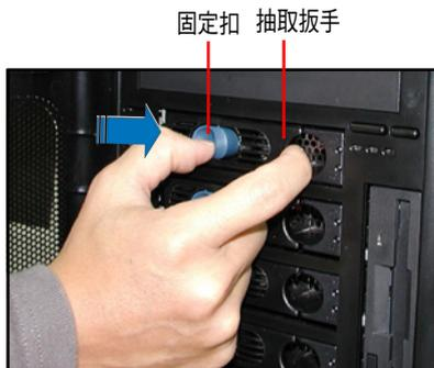
3. 握緊抽取板手並向外拉便可取出磁碟槽。
