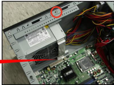
6. 將支撐架從箭頭所示的方向抽開，並從機殼中取出。
