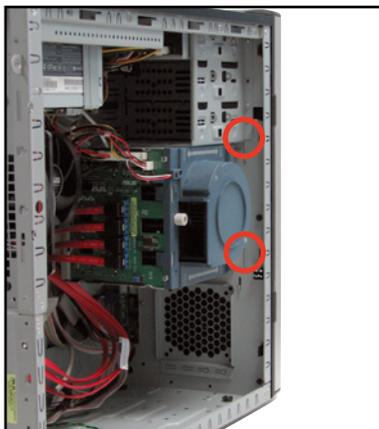
3. 如圖所示，將機殼前端的鎖扣向外拉，以鬆開前面板組件。
