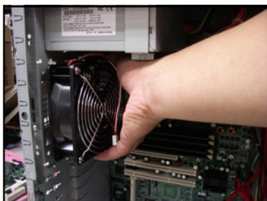
4. 接著將固定在風扇上的金屬防護罩的自攻牙螺絲卸除，就可以更換風扇。
