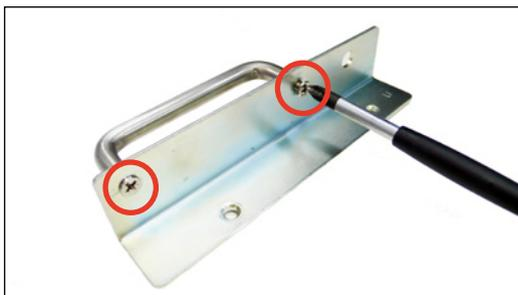
3. 如下圖，移除機殼底部的 4 顆螺絲。
