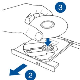
4. Appuyez sur la partie centrale du disque jusqu'à ce que celui-ci s'enclenche dans le plateau.
