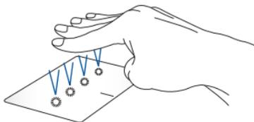
Frappez rapidement le pavé tactile avec quatre doigts pour ouvrir le centre d'action.
