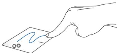
Frappez deux fois sur un élément et maintenez votre doigt sur le pavé tactile en le faisant glisser jusqu'à l'endroit voulu. Désengagez votre doigt du pavé tactile pour placer l'objet à l'endroit voulu.
