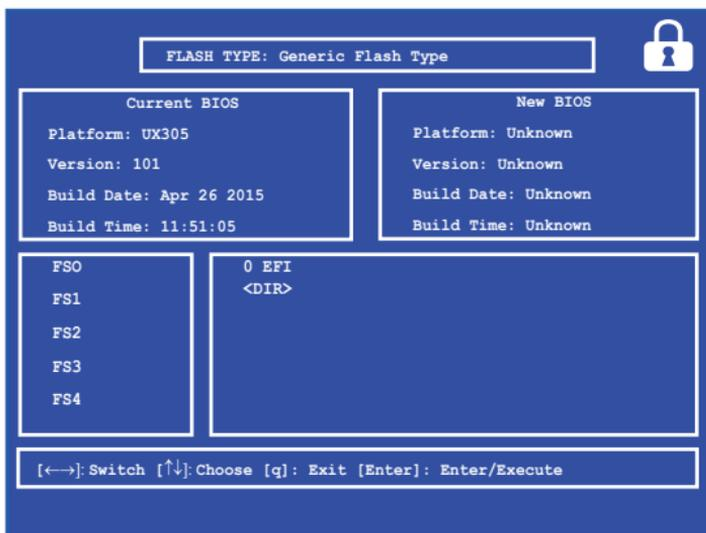
7. Después del proceso de actualización de la BIOS, haga clic en **Exit (Salir) > Restore Defaults (Restaurar valores predeterminados)** para restaurar la configuración predeterminada del sistema.
