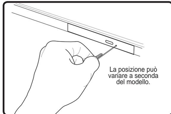
Il foro per l'apertura di emergenza si trova sull'unità ottica e viene utilizzato per far fuoriuscire il vassoio del drive ottico qualora l'apertura elettronica non funzionasse. Non utilizzare l'espulsione d'emergenza al posto di quella elettronica. **Nota: fate attenzione a non confondere la spia dell'indicatore di attività che si trova nella stessa zona.**
