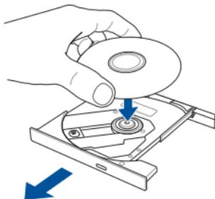
4. Empurre o cubo de plástico do disco até que se encaixe no cubo da unidade óptica.
