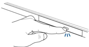
2. 请将光驱托盘完全拉出。
