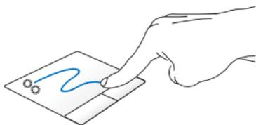
轻触两下以选择图标，然后用相同手指在板面上滑动即可拖曳该图标。放开手指以将图标放至新位置。
