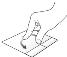
Tenendo un dito fermo sul touchpad ruotate l'altro dito in senso orario o antiorario.
