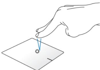
Tapnite tačped pomoću dva prsta da biste simulirali funkciju desnog klika.
