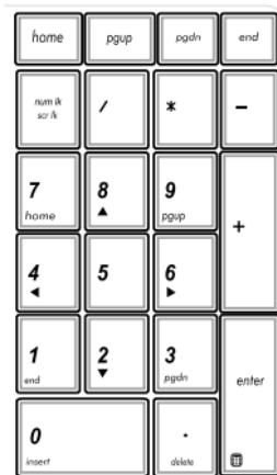
บุ่มตัวเลขมีบนโน๊ตบุ๊ค PC บางรุ่น คุณสามารถใช้บุ่มตัวเลขนี้ สำหรับการบันทึกตัวเลข หรือเป็นบุ่มการเลื่อนทิศทางของตัวชี้
