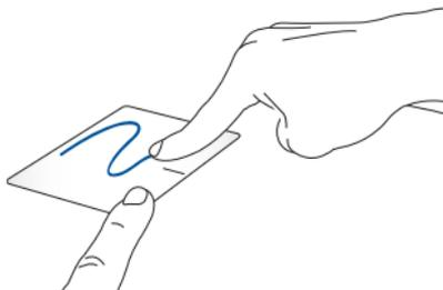
选择图标之后按住左键，然后用另一根手指在触摸板向下滑动以拖曳并将图标放置于新的位置。
