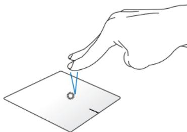
用两根手指轻触触摸板以模拟点击鼠标右键功能。
