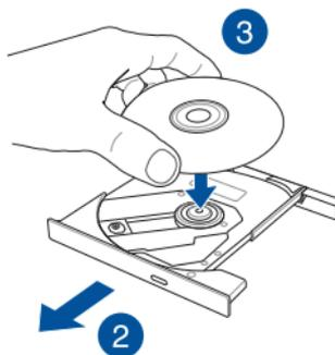
4. 将光盘中央的塑胶圈环向下压直到与光驱托盘完全接合。
