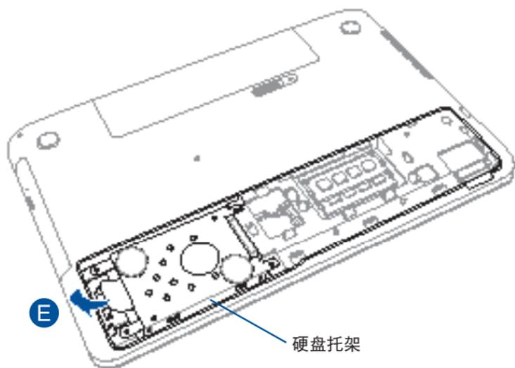
F. 若硬盘与硬盘托架连接，请参考下列步骤移除旧硬盘：
