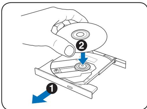
3. Segure o disco pelas pontas e coloque a parte impressa do disco para cima. Empurre em ambos os lados do centro do disco até que o disco se encaixe no núcleo. **O núcleo deve estar maior que o disco, quando corretamente montado.**
