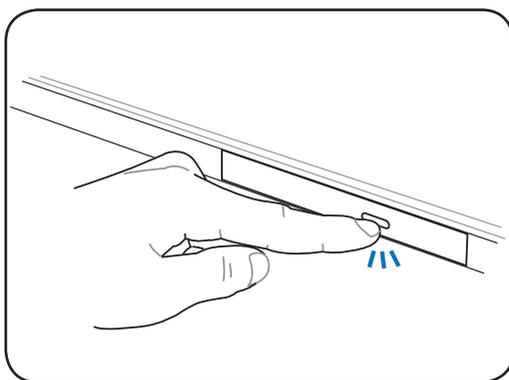
2. Suavemente, puxe o painel frontal do drive e deslize a bandeja completamente para fora. Cuidado para não tocar as lentes do drive de CD e outros mecanismos. Certifique-se que não há obstruções que possam prender-se sob a bandeja do drive.
