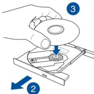
4. Plastično zvezdišče diska potisnite navzdol, da se zatakne v zvezdišče optičnega pogona.
