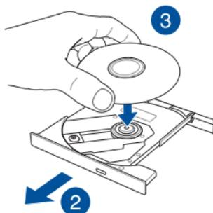
4. Drücken Sie das Medium auf die Kunststoffachse, bis es sicher auf der Achse des optischen Laufwerks sitzt.
