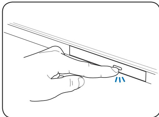
2. ドライブのフロントパネルをそっと引きながら、トレイをスライドさせて完全に出します。光学ドライブのレンズや他の機械部分には触れないように注意してください。ドライブのトレイの下に障害物がないことを確認してください。
