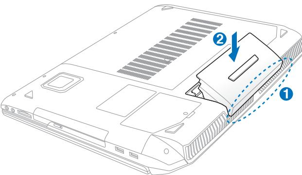
1. バッテリーパックのピンの位置を本体バッテリースロットのコネクター部の位置に合わせます。
