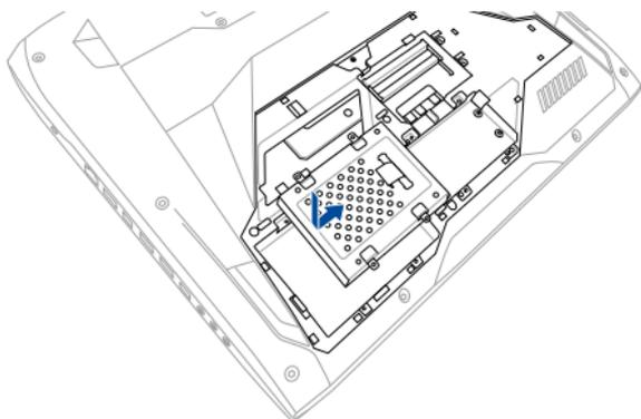
N. 重新鎖回之前移除的螺絲以固定硬碟托架。
