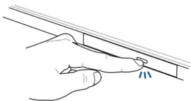
2. 請將光碟機托盤完全拉出。
