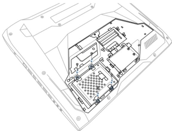
G. 將硬碟托架與硬碟連接埠分離並從插槽中取出硬碟托架。
