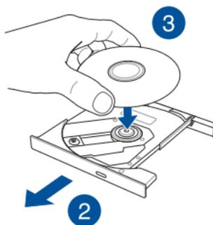
4. Drücken Sie das Medium auf die Kunststoffachse, bis es sicher auf der Achse des optischen Laufwerks sitzt.
