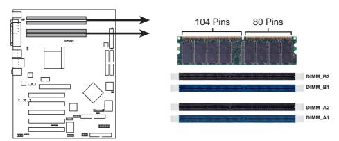
SK8N 184-Pin DDR DIMM Sockets
