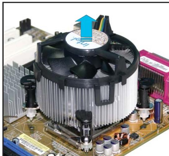
5. Drehen Sie jeden Druckstift im Uhrzeigersinn, um eine richtige Ausrichtung bei Neuinstallation sicherzustellen.
