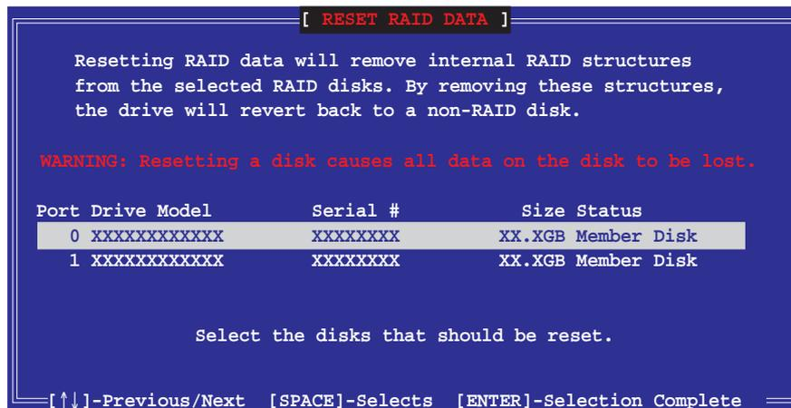
2. Wählen Sie mit den Oben-/Unten-Pfeiltasten das RAID-Laufwerk, das zurückgesetzt werden soll, und drücken Sie die <Leertaste>.
