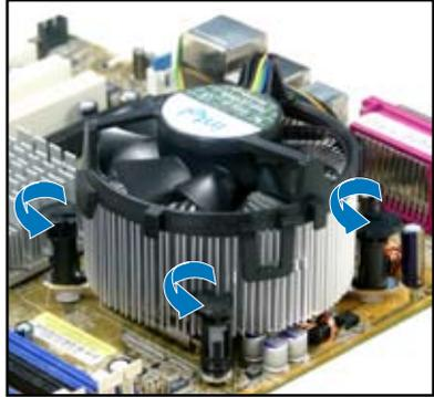
3. 依照順序將扣具扳離主機板上的散熱器插孔，採對角線方式移除，例如：先移除 A，再移除 B；或是先移除 B，再移除 A。
