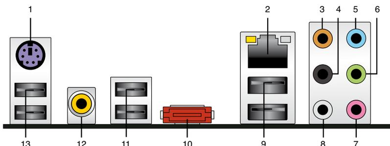
1. PS/2 鍵盤連接埠（紫色）：將 PS/2 鍵盤插頭連接到此埠。
