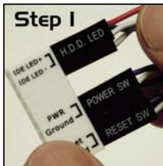
2. 將華碩 Q-Connector 正確的安裝至系統插座上。
