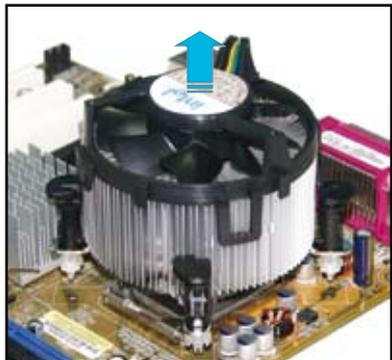
5. 以順時針的方向旋轉每一個扣具至初設定時的位置，如圖所示。
