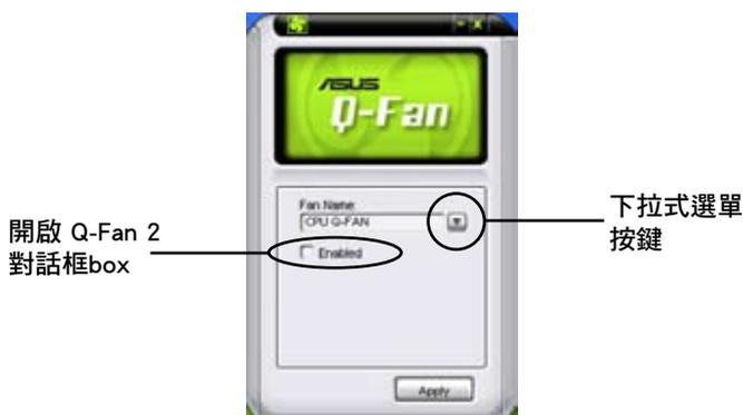
在您勾選 Enable Q-Fan 2 對話框後，預設值列表 (Profile List) 便會出現。請點選下拉式選單並選擇一個 profile 預設值。最佳化 (Optimal) 模式可讓系統依照溫度的變化自動調節風扇轉速；寧靜 (Silent) 模式則會將風扇運作轉速降至最低；而效能 (Performance) 模式則會提高風扇轉速以得到最佳得系統冷卻效果。
