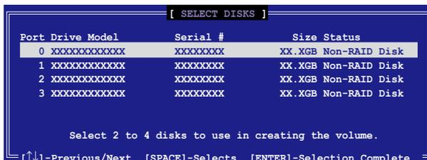
5. Benutzen Sie die Oben-/Unten-Pfeiltaste, um ein Laufwerk zu unterlegen, dann drücken Sie die <Leertaste>, um es auszuwählen. Ein kleines Dreieck markiert das gewählte Laufwerk. Drücken Sie die <Eingabetaste>, wenn Sie mit der Auswahl fertig sind.
