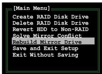
2. Bewegen Sie sich mit <TAB> durch das RAID Disk Drive List-Menü und wählen Sie das RAID-Set, das wiederhergestellt werden soll. Drücken Sie <Del>, um mit dem Wiederherstellen der Mirror-Konfiguration zu beginnen. Eine Statusleiste an der Bildschirmunterseite zeigt den Fortschritt der Wiederherstellung an.
