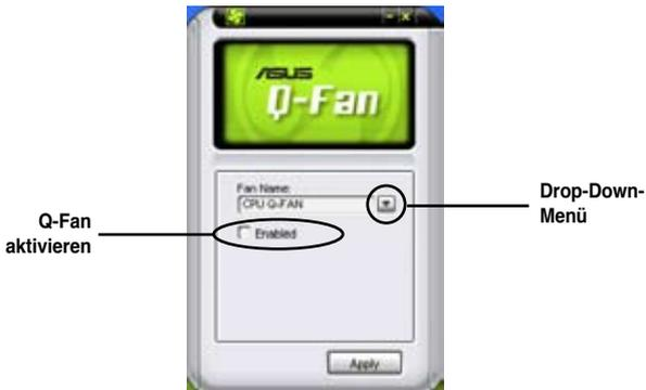
Nach dem Klick auf **Enable Q-Fan** erscheint die **Profile**-Liste. Klicken Sie auf die Drop-Down-Listenschaltfläche und wählen Sie ein Profil. Der **Optimal**-Modus regelt die Drehzahl entsprechend der Temperatur, der **Silent**-Modus minimiert die Lüfterdrehzahl für einen leisen Betrieb und der **Performance**-Modus erhöht die Drehzahl auf das Maximum, um die größten Kühlwirkung zu erzielen.
