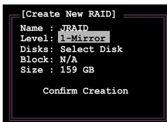
3. Wenn das Element **Disks** markiert ist, markieren Sie mit den Oben/Unten-Pfeiltasten die Festplatte, die Sie dem RAID\_Set zuordnen möchten, und drücken Sie danach auf die <Leertaste>, um die Auswahl zu bestätigen. Wiederholen Sie diesen Vorgang, bis alle Festplatten ausgewählt sind. Eine ausgewählte Festplatte wird durch das davorstehende ►-Zeichen angezeigt.
