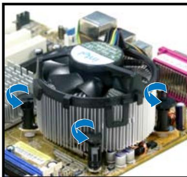
3. Tirez vers le haut deux systèmes de serrage en même temps en séquence diagonale pour dégager l'ensemble dissipateur-ventilateur de la carte mère.
