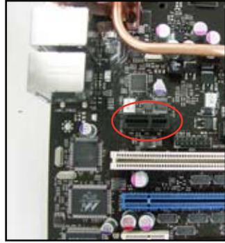
3. Alignez le connecteur de la carte sur le slot et appuyez fermement jusqu'à ce que la carte soit complètement insérée dans le slot.
