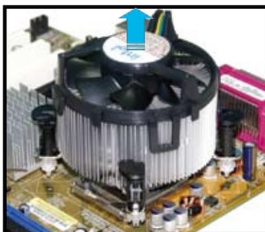
5. Tournez chaque mécanisme de serrage dans le sens des aiguilles d'une montre pour avoir une bonne orientation lors d'une réinstallation.
