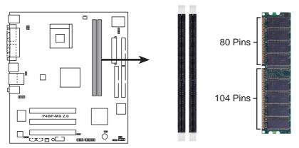
P4BP-MX 2.0 184-Pin DDR DIMM Sockets
