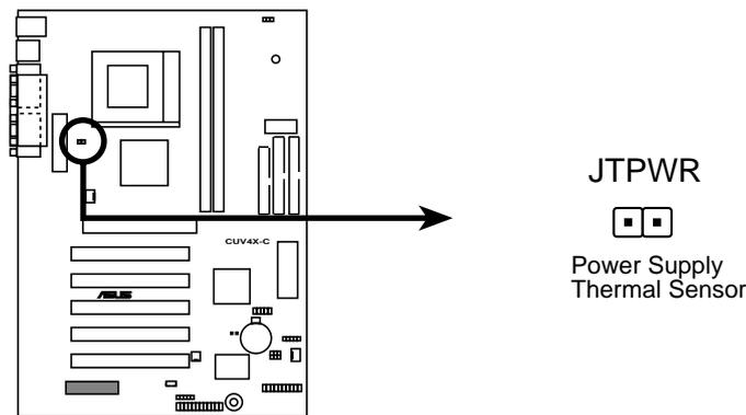
**CUV4X-C Thermal Sensor Connector**
