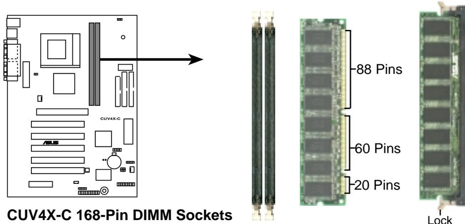
**CUV4X-C 168-Pin DIMM Sockets**
