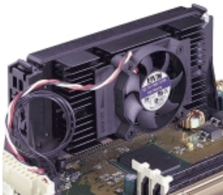
SECC Heatsink & Fan
