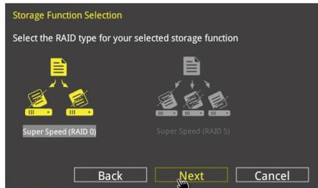
4. Nach der Auswahl des RAID-Typs, klicken Sie auf **Weiter** und dann auf **Ja**, um mit dem RAID Setup fortzufahren.
