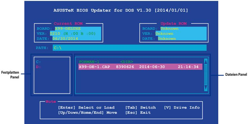
3. Drücken Sie die Taste <Tab>, um zwischen den Feldern zu wechseln und wählen Sie die BIOS-Datei mit den <Bild auf/Bild ab/Pos 1/Ende>-Tasten; anschließend drücken Sie die **Enter**-Taste.
