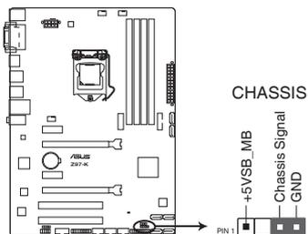
Connecteur d'intrusion châssis de la Z97-K
