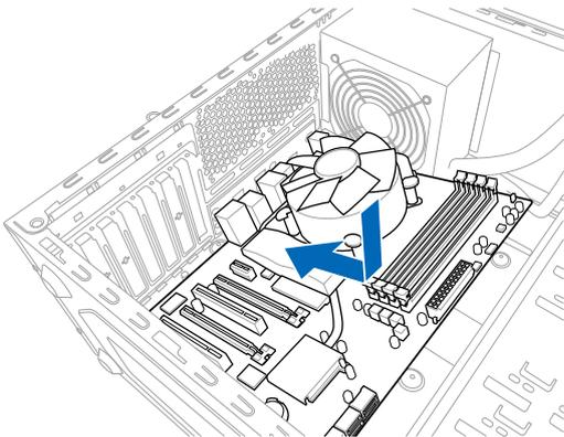
3. 將九個螺絲放入主機板上的螺絲孔並旋轉鎖緊，以確保將主機板鎖至機殼。
