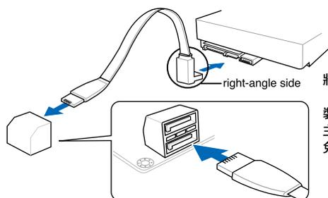
將 SATA 訊號線上的直角接頭端 (right angle side) 連接在 SATA 裝置上，或是將直角接頭端安裝至主機板內建的 SATA 連接埠，以避免造成與較大顯示卡的衝突。
