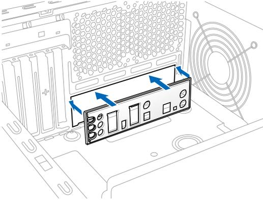
2. 將主機板放入機殼，並確認後側 I/O 連接埠對齊機殼的後側 I/O 面板。
