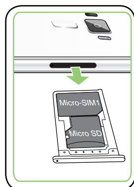
4. Нажмите лоток привода для его закрытия.
