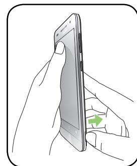
3. Приподнимите крышку и снимите ее.
