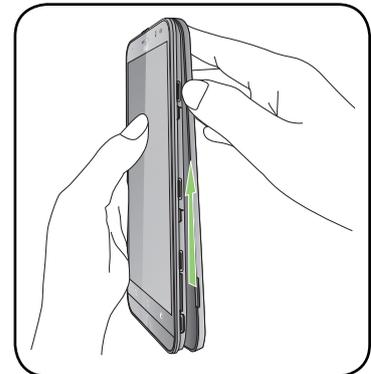
4. Insérez votre carte micro SIM dans l'une des fentes, puis remplacez la batterie et le couvercle.
