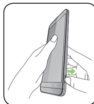
3. Désengagez lentement le couvercle arrière de la coque de l'appareil.
