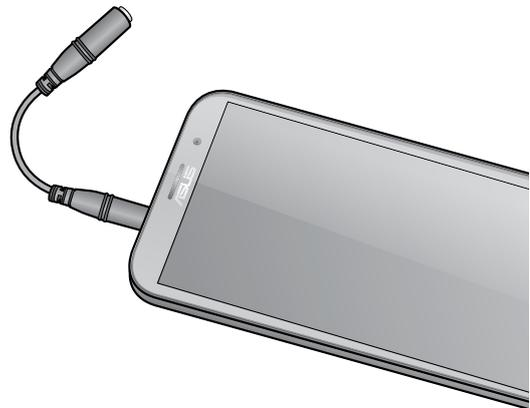
Se você quiser usar seu fone de ouvido, ao conectar o cabo da antena, certifique-se de que você inseriu o o cabo do seu fone de ouvido 3,5 mm completamente na antena.
