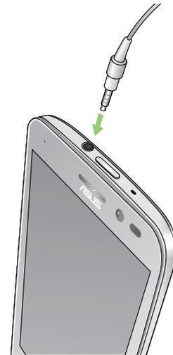
Quando você conectou o cabo da antena, certifique-se de que você inseriu o cabo do seu fone de ouvido 3,5 mm completamente na antena.
