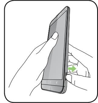
3. Para retirar a tampa traseira, erga a tampa solta da ranhura indo para cima, depois da ranhura para baixo em uma direção para a esquerda.
