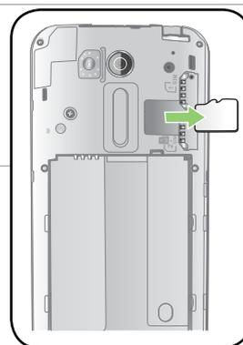
4. Rimuovete la microSD dall'alloggiamento microSD.
