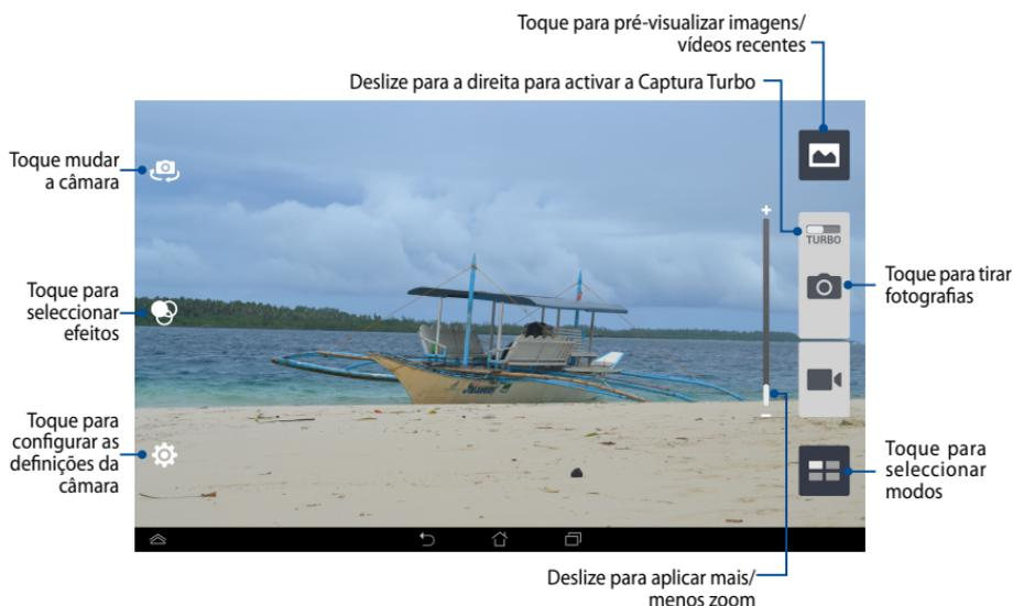
A aplicação da Câmara permite tirar várias fotografias em sucessão rápida utilizando a função Captura Turbo. Com esta função, poderá seleccionar a melhor fotografia ou ordená-las numa sequência.
