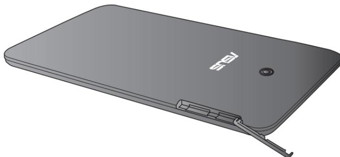
2. Masukkan kartu SIM mikro ke salah satu slot kartu SIM mikro dengan bidang kontak logam menghadap ke atas.
