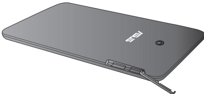
2. Masukkan kartu microSD ke slot kartu microSD dengan bidang kontak logam menghadap ke atas seperti pada gambar.
