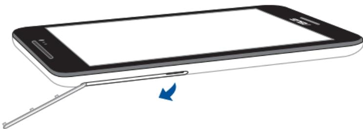
2. Inserte la tarjeta micro-SIM en cualquiera de las ranuras para tarjetas micro-SIM con los contactos metálicos orientados hacia arriba.
