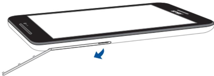
2. Inserte la tarjeta microSD en la ranura para tarjetas microSD con los contactos metálicos orientados hacia arriba, tal y como se muestra en la figura.
