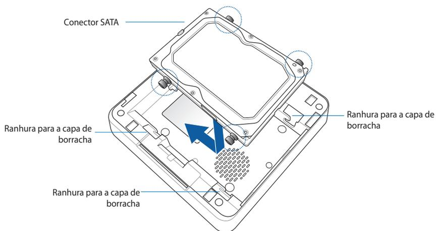
Voltar a instalar o adaptador de tabuleiro de unidade (com o SSD no inteiro) no compartimento da unidade
