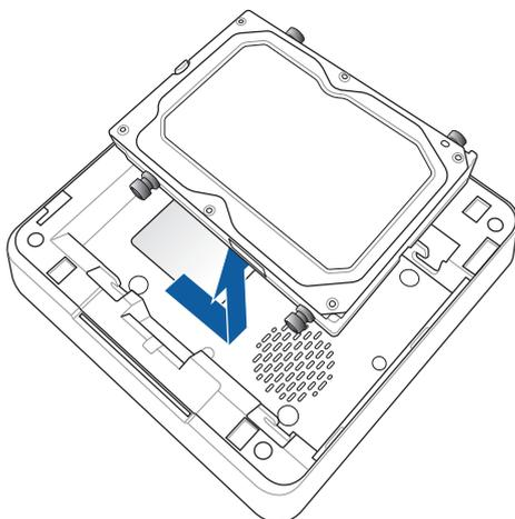
Retirar o SSD do adaptador de tabuleiro de unidade (com o SSD no interior) do compartimento da unidade
