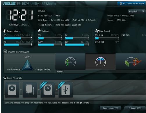
2. Нажмите **Exit/Advanced Mode** в правом верхнем углу экрана и выберите **Advanced Mode**. На экране **Advanced Mode** выберите **Monitor**.
